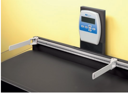
Resim 1. İki yaşın altındaki çocuklarda boy ölçümü için kullanılan dijital göstergeli infantometre
